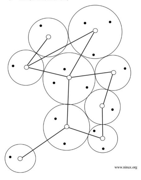
Nella configurazione ninux.org 1.0 gli access point sono configurati in bss, per cui si ha la struttura di nodi "master" con relativi client.
